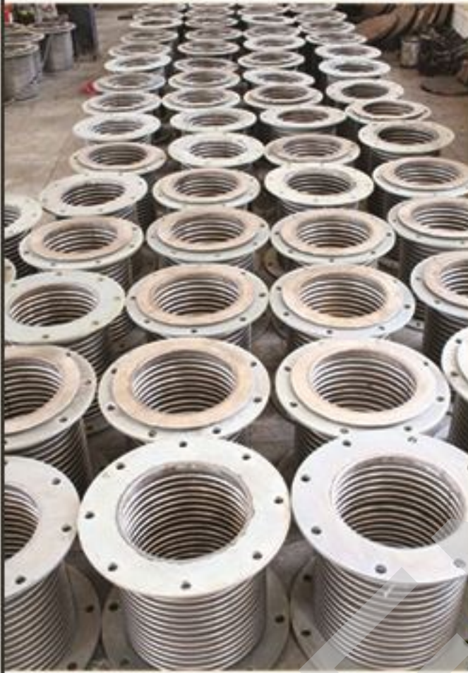
اتصال آگار دوشی ۱۰" (شرکت ایریتک - پروژه احیای فولاد قاننات)
